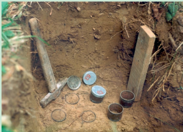
Slika 4: Odvzem talnih vzorcev s Kopeckyjevim valji (foto: M. Urbančič)
