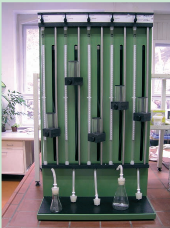
Slika 9: Kalcimeter za laboratorijsko določevanje karbonatov v tleh (foto: Daniel Žlindra)
