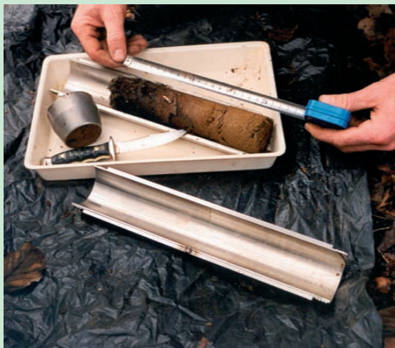
Slika 2: Odvzem talnega vzorca z razklopno valjasto sondo (foto: M. Urbančič)
