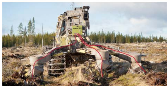
Slika 6: Setvena enota (zgoraj) in njena postavitve na forwarder (sredina in spodaj)
