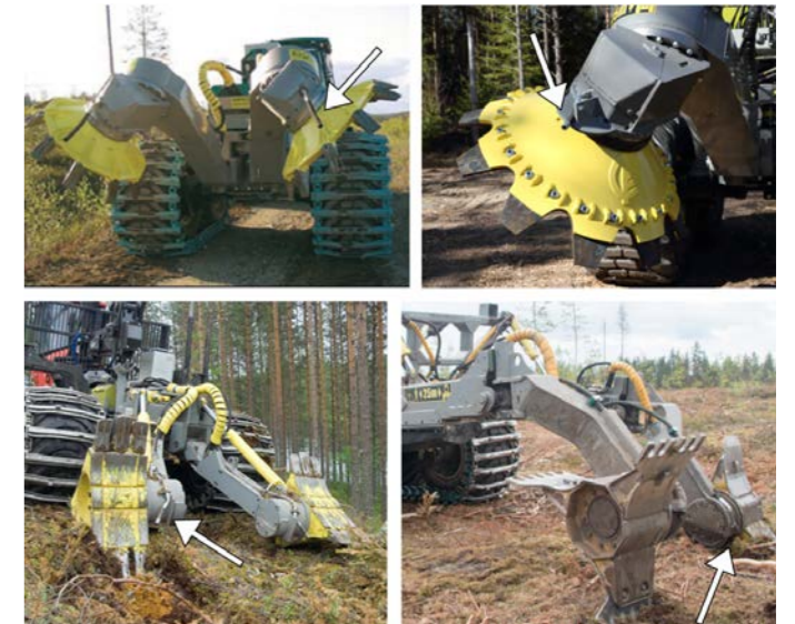
Slika 3: Zgoraj je prikazan diskasti plug, spodaj pa plug za nekontinuirano obračanje zemlje
