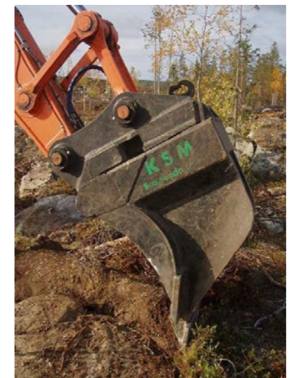
Slika 5: Prilagojena izkopna žlica za točkovno mehanizirano setev
