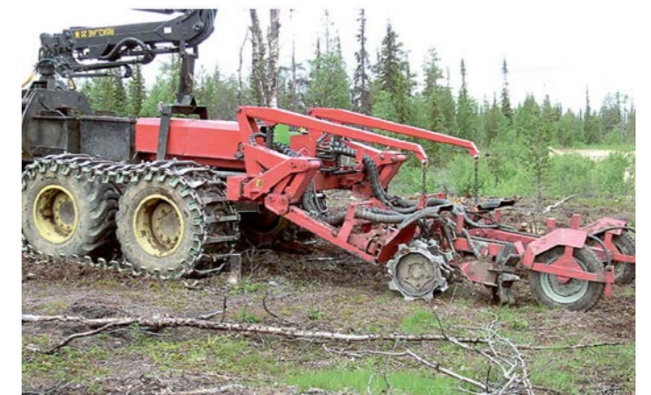
Slika 4: Skrajno desno se za rotovatorjem nahaja posebno kolo za mikro-pripravo tal.
