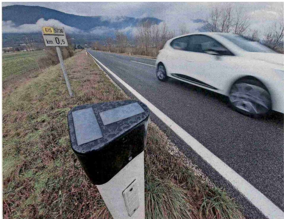
Zvočna odvratala, ki oddajajo za divjad moteč visokofrekvenčni zvočni signal, so se v minulem letu izkazala za bolj učinkovita v "boju" z divjadjo od svetlobnih.
