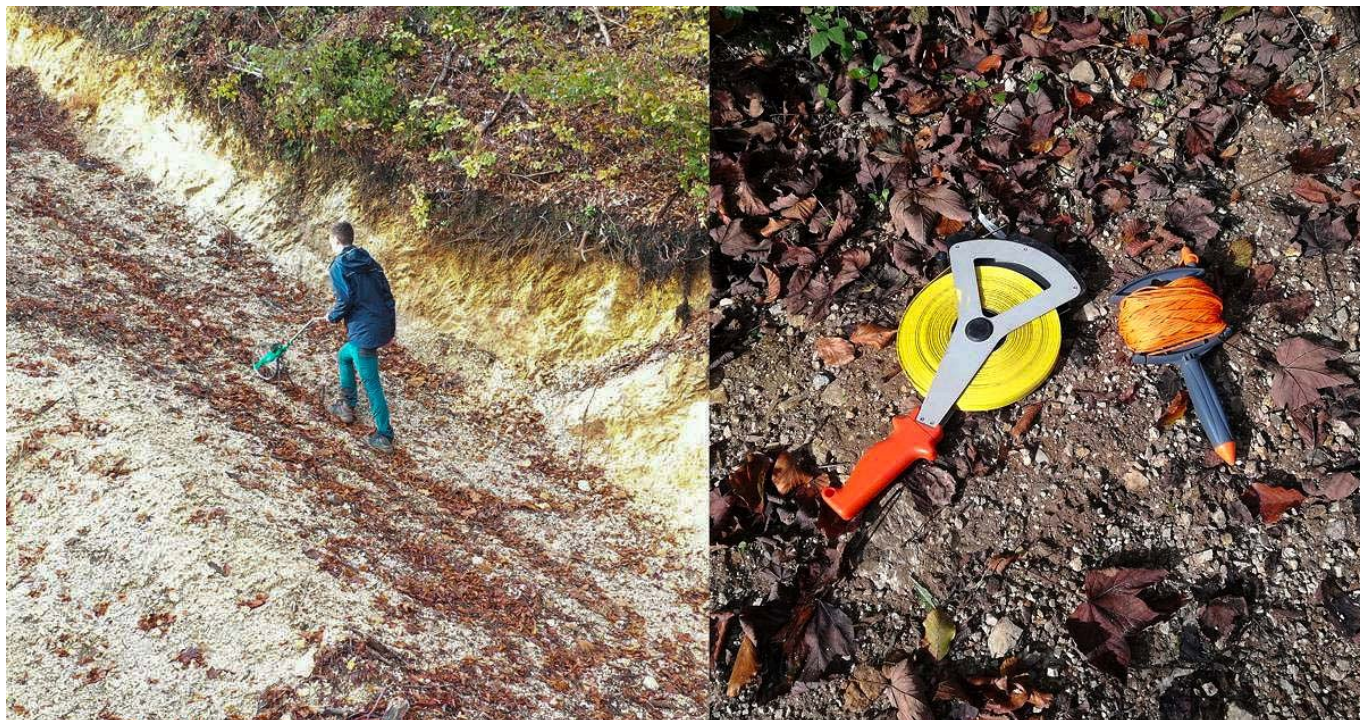
Slika 3: za meritve dolžine lahko profesionalno merilno kolo (levo) nadomestimo z vrvico in daljšim tračnim metrom (desno) (Foto: J. Saražin)
