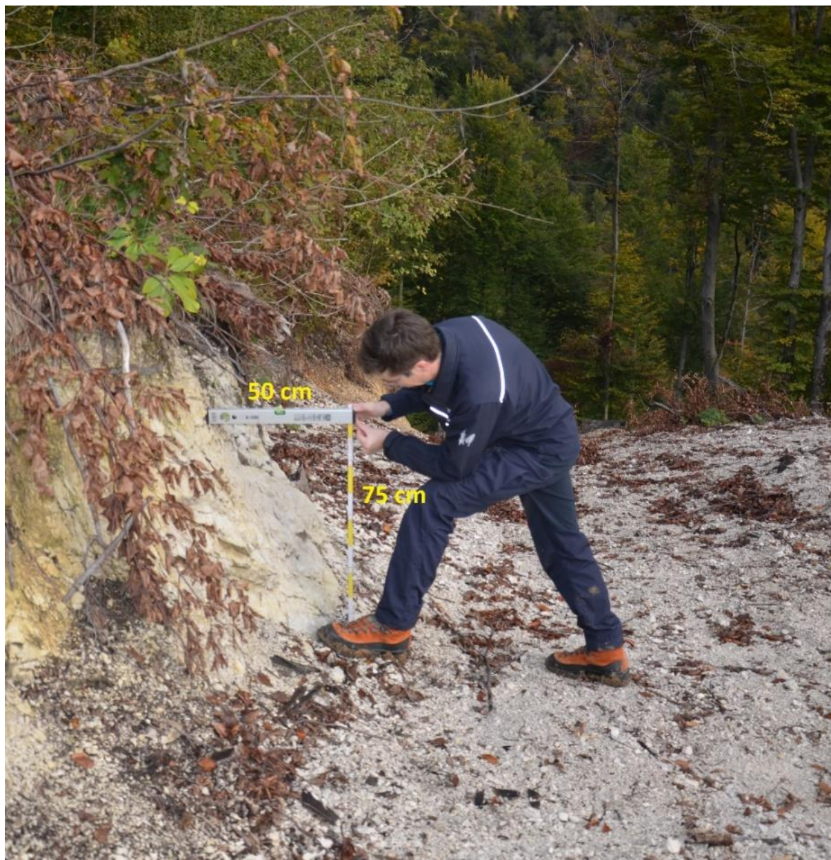
Slika 6: Primer merjenja naklona odkopne brežine z libelo in metrom. Na sliki je prikazan naklon odkopne brežine 75 cm / 50 cm = 150 %, oz. običajno v elaboratu vlake zapisano kot 3:2
