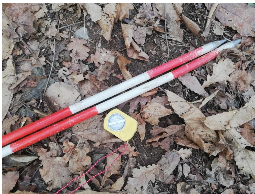
Slika 5: Z merjenjem naklona z libelo in metrom lahko nadomestimo meritve s padomerom in trasirko. Primer na sliki prikazuje vzdolžni naklon vlake 56 cm / 200 cm = 28 %. (Foto: G. Ogrin)
