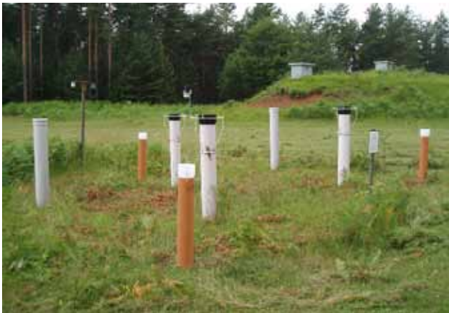
a) Slika 3. Vzorčevalniki za usedline na ploskvi Brdo a) na prostem in b) v sestoji (Foto: Daniel Žlindra)
