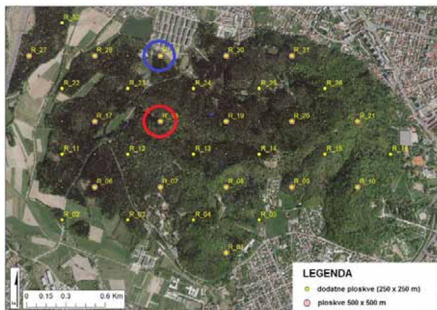
Slika 3. Vsebnost svínca (Pb) presega opozorilno vrednost (100 mg/kg) le na eni ploskvi v Mostecu (140 mg/kg, rdeči krog). Tudi mejna vrednost (200 mg/kg) cínka (Zn) je bila presežena le na ploskvi v bližini Koseškega bajerja (201,6 mg/kg, modri krog). Kritične vsebnosti težkih kovín v gozdnih tleh niso bile presežene na nobeni ploskvi.
