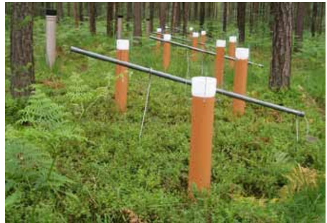
a) Slika 3. Vzorčevalniki za usedline na ploskvi Brdo a) na prostem in b) v sestoji (Foto: Daniel Žlindra)
